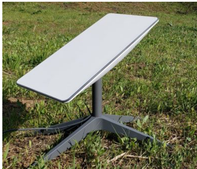
Starlink-Antenne auf Stativ mit Phased-Array
